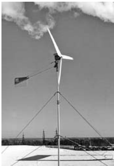
Рис. 7. Ветроустановка УВЭ-500 мощностью 500 Вт производства ТНЦР-ЦНИИ «Электроприбор».
